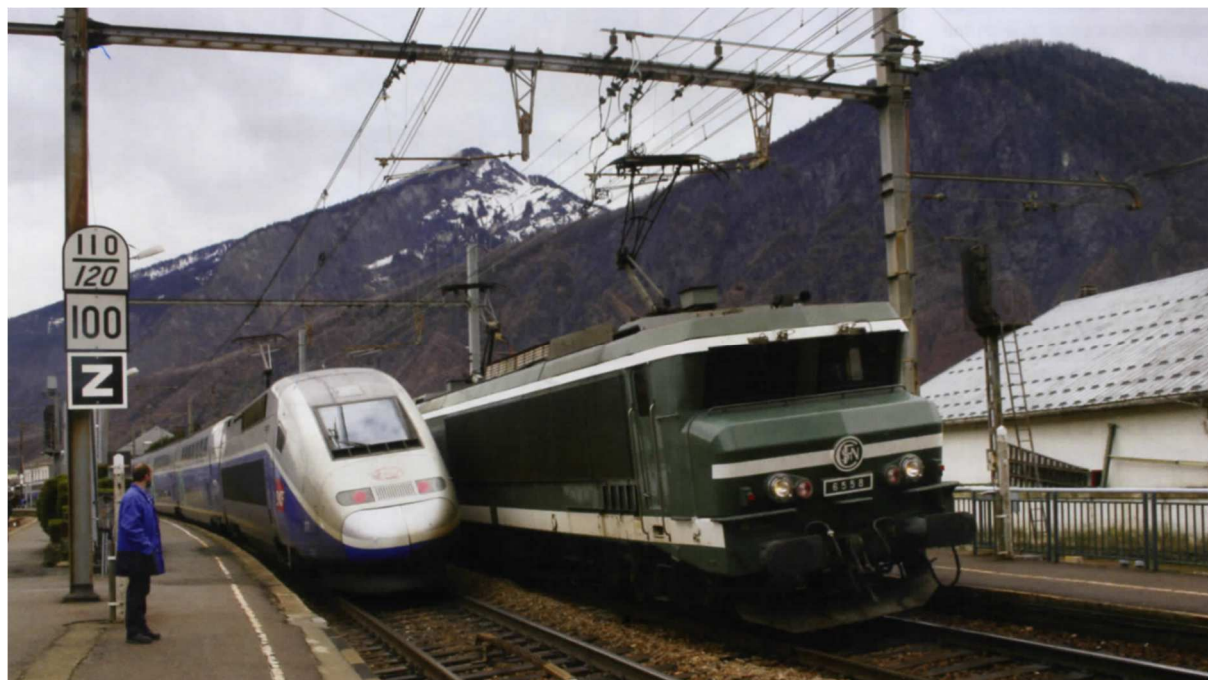
Dévers et triple signalisation en gare de St Jean-de Maurienne (Le Rail n° 221-222)
