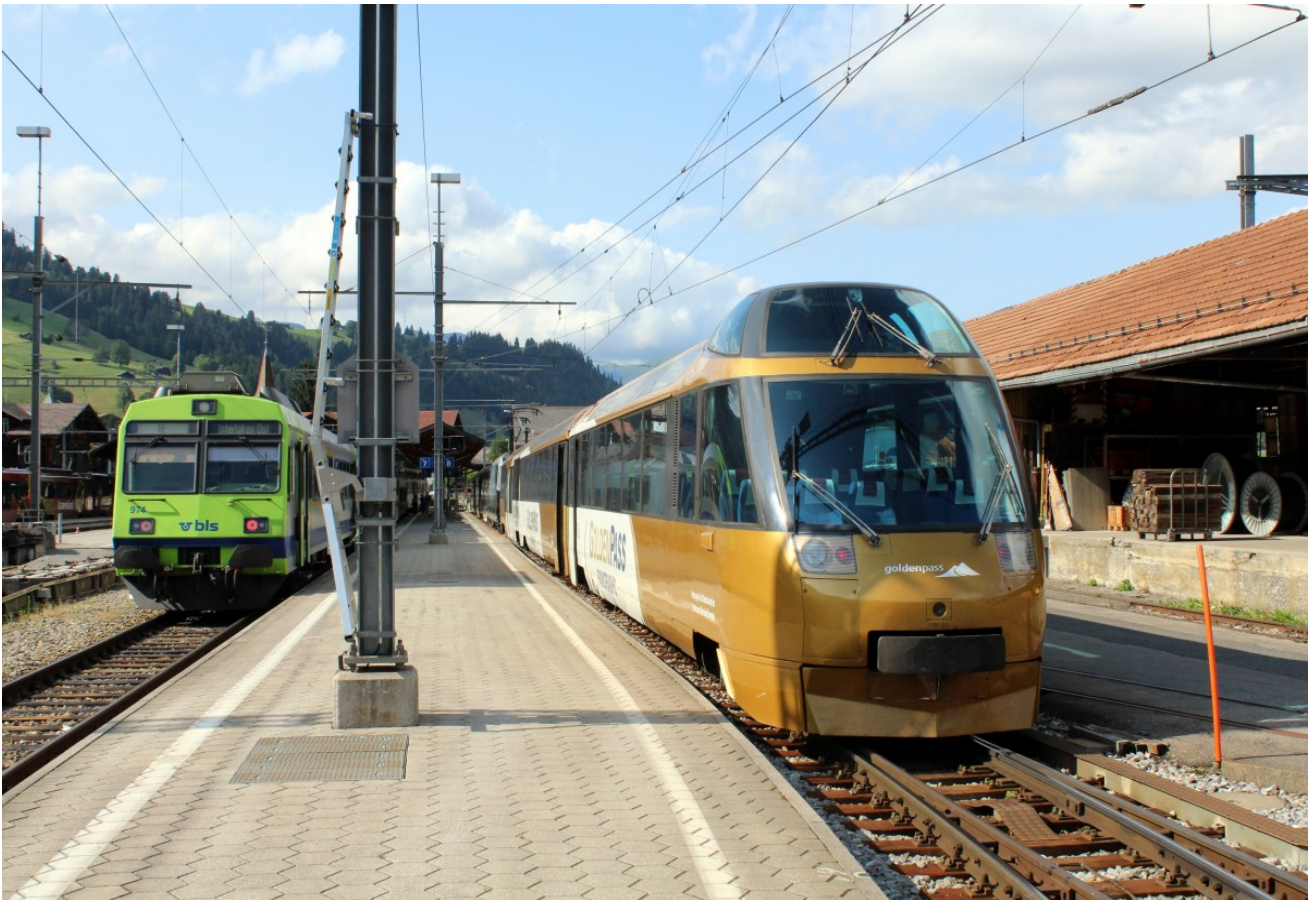
Côte à côte : le réseau BLS à gauche sur voie 1 435mm, le MOB à droite sur voie 1000mm. D'ici peu, les trains du MOB passeront d'un écartement à l'autre grâce à un appareil de changement d'écartement des essieux (photo wikipedia)
